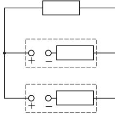
Iz simetrije vezave vidimo, da skozi vsako baterijo teče polovico toka, ki teče skozi upornik. Napetost v električnem krogu nam da enačbo za tok  $I_2$ :
