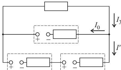
Naj teče skozi vejo z eno baterijo tok  $I_0$  in skozi upornik tok  $I_3$ . Vsota napetosti v električnem krogu z upornikom in eno baterijo da enačbo
