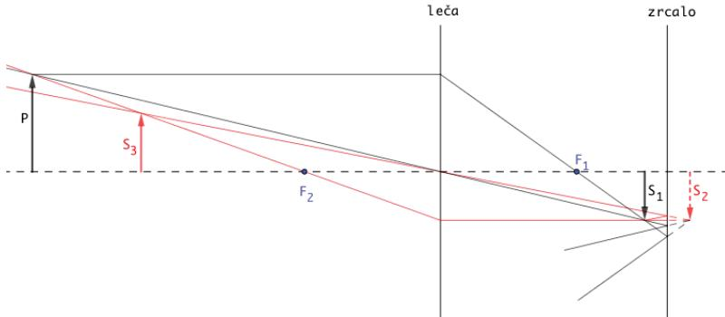
c) Ko zrcalo približamo leči, se svetloba, ki od predmeta prehaja skozi lečo, na zrcalu odbije preden tvori realno sliko. **Prva realna** slika  $S_4$  zato nastane  $b_1 - 16 \text{ cm} = 2 \text{ cm}$  pred zrcalom oziroma v oddaljenosti  $a_3 = 14 \text{ cm}$  od leče. Svetloba še enkrat potuje skozi lečo in v razdalji  $b_3 = \frac{a_3 f}{a_3 - f} = 84 \text{ cm}$  nastane **druga realna** slika  $S_5$ , na isti strani leče kot je predmet.
