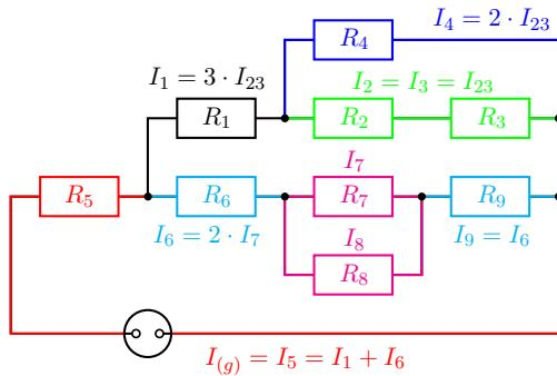
V spodnji veji vezja (porabniki  $R_6$ ,  $R_7$ ,  $R_8$  in  $R_9$ ) teče skozi porabnik  $R_7$  tok  $I_7$ . Skozi porabnik  $R_8$  teče enak tok,  $I_8 = I_7$ , skozi  $R_6$  in  $R_9$  pa teče isti tok  $I_6 = I_9 = I_7 + I_8 = 2 \cdot I_7$ . Za napetosti na porabnikih v tej veji lahko zapišemo  $U_7 = U_8 = U_{78}$  in  $U_6 = U_9 = 2 \cdot U_{78}$ .
