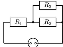
Napetost  $U_{23}$  na porabnikih  $R_2$  in  $R_3$  je enaka tretjini napetosti vira, kar pomeni, da skozi  $R_2$  in  $R_3$  tečeta tokova  $I_2 = I_3 = \frac{1}{3}I_{(a)} = 6,67 \text{ mA}$ , skozi vir pa isti tok kot skozi prvi porabnik  $R_1$ ,  $I_{(e)} = I_1 = 2 \cdot I_2 = \frac{2}{3}I_{(a)} = 13,3 \text{ mA}$ . Čas  $t_{(e)}$ , v katerem se baterija izprazni, je
