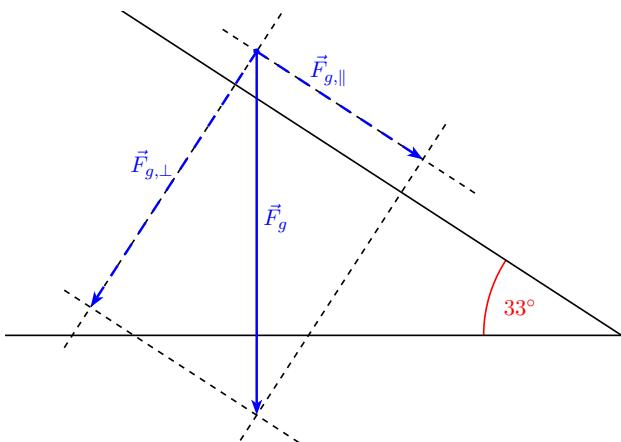
Rezultanta  $\vec{F}_{g,\perp}$  in  $\vec{F}_{p,\perp}$ , po velikosti enaka  $F_{r,\perp} = F_{p,\perp} - F_{g,\perp}$ , povzroči Petrovo ustavljanje v smeri pravokotno na podlago s povprečnim pojmemkom  $\bar{a}_{\perp}$ ,
