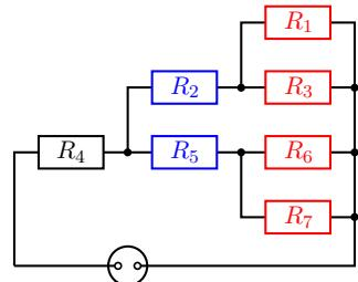
Vsota enakih tokov  $I_1$  in  $I_3$  je tok  $I_2$  skozi porabnik  $R_2$  (ki mu je ekvivalenten porabnik  $R_5$ ),  $I_2 = I_1 + I_3 = 2 \cdot I_1$ , torej velja
