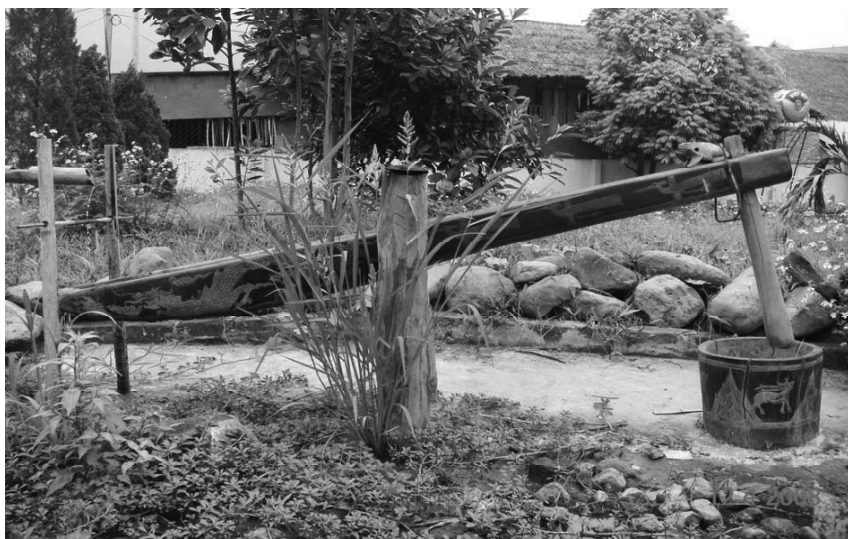
Slika 1: Tolkač riža na vodni pogon.
