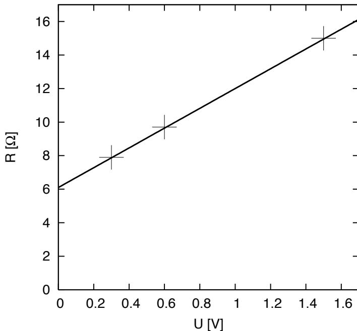
f) Na žarnici  $\check{Z}_2$  je napetost  $U = 1$  V; pri e) smo za ta primer izračunali tok 83 mA. Na žarnicah  $\check{Z}_3$  in  $\check{Z}_4$  sta napetosti po 0,5 V. Iz grafa za ta primer dobimo za vsako od žarnic  $\check{Z}_3$  in  $\check{Z}_4$  upor  $R = 9,05 \Omega$ . Iz napetosti dobimo še tok  $I_3 = 55$  mA. Za moči na posameznih žarnicah končno dobimo:  $P_2 = UI_2 = 83$  mW,  $P_3 = P_4 = \frac{1}{2}UI_3 = 28$  mW.
