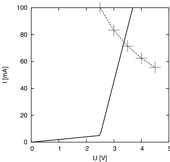
Točke povežimo; iskana rešitev za tok in napetost je v presečišču krivulje skozi točke in krivulje (premice), ki podaja karakteristiko diode. Dobimo
