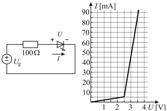
Svetleča dioda oddaja 20 % moči v obliki svetlobe, ostalo pa so toplotne izgube. Predpostavi, da je temperaturna razlika med ohišjem svetleče diode in okolico premo sorazmerna s toplotnim tokom, ki ga dioda oddaja v okolico. Sorazmernostni koeficient je  $250\text{ K/W}$ .
