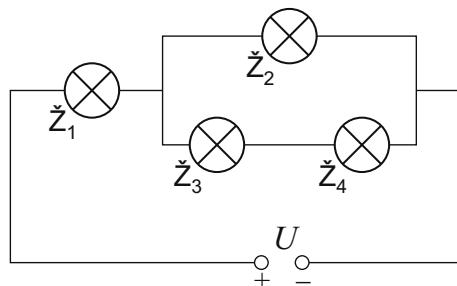
Napetost na žarnici  $\check{Z}_1$  je  $1,50 \text{ V}$ , tok skozi žarnico  $\check{Z}_2$  je  $62,0 \text{ mA}$ , napetost na žarnici  $\check{Z}_3$  je  $0,30 \text{ V}$ .
