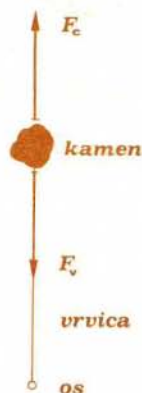
Slika 3a: Kamen v vrtečem se opazovalnem sistemu miruje. Nanj delujeta dve sili, katerih vsota je enaka nič: sila vrvíce F_v in centrifugalna sistemska sila F_c .
