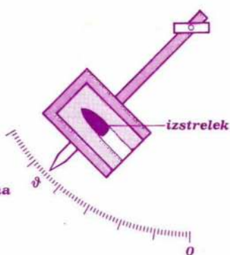
Sl.8 Potem ko je izstrelek zadel balistično nihalo, se je odklonilo za kot \theta .
