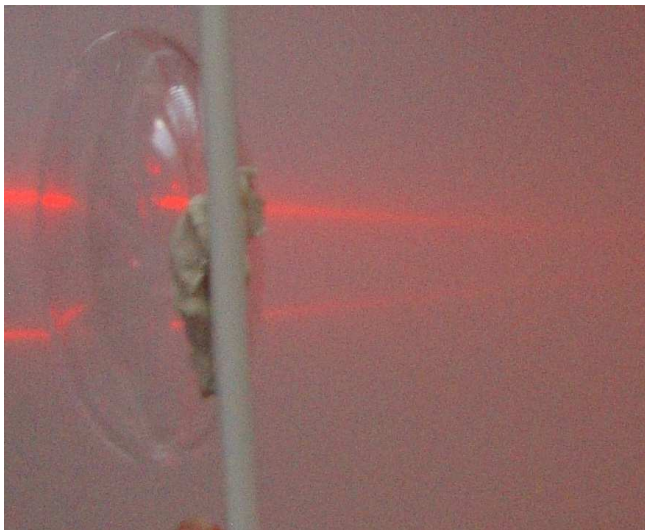
SLIKA 6. Parafinska leča, potopljena v vodo, je zbiralna leča. Da je potek curkov po izhodu iz leče vidnejši, smo morali prostor zatemniti, sliko pa nekoliko osvetliti. Svetloba vpada z leve strani. Pogled od zgoraj.
