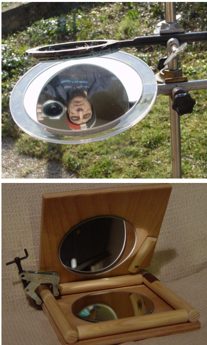
SLIKA 18. 70-stopinjski razpor dveh konkavnih krogelnih zrcal
