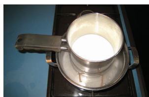
Slika 4. Posoda za kuhanje mleka ( http://www.sakthifoundation.org/fast-kitchen-intro-3.htm (levo). Presek posode za kuhanje mleka (desno). Pri odprtini za ventil nalijemo vodo v medprostor in privijemo ventil. Ko voda v medprostoru zavre, odvečna para sika skozi ventil, mleko pa ne kipi.
