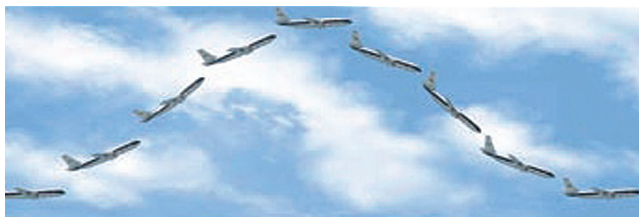
Slika 1. Letalo C9 se najprej dvigne in nato spusti po paraboli. Med pospešenim dviganjem učinkoviti pospešek naraste, med prostim padanjem pa nastopi mikrogravitacija. Vpliv zračnega upora v redkejšem zraku delno izravna z izbiro poti. Pot je nakazana le shematično, na vsakem od obeh krakov letalo prepotuje skoraj 10 kilometrov. Slika je vzeta iz članka R. Dempsey, G. A. DiLisi, L. A. DiLisi, G. Santo, Thank you for flying the Vomit Comet , The Physics Teacher 45 (2007) 72. (NASA)
