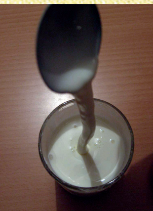
Slika 2. Če mešanico zajamemo z žlico in pustimo, da iz žlice odteče, je curek izrazito neenakomeren in neraven.
