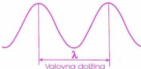
Slika 1. Valovna dolžina \lambda je razdalja med dvema sosednjima valovnima vrhovoma ali valovnima dolinama. Frekvenca \nu je povezana z valovno dolžino z enačbo c = \lambda\nu . Enota za valovno dolžino je m, za frekvenco pa s^{-1} ali Hz.
