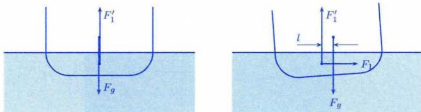
Slika 3. Sile in komponente, ki delujejo na brod v navpični smeri na mirujoči vodi (a). Med gibanjem proti toku navor dvojice teže in vzgona lF'_1 uravnovesi navor upora trupa r_1F_1 (b).
