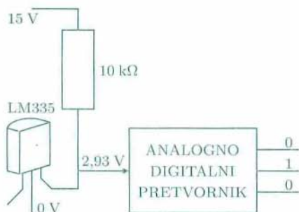
Slika 1. Električni termometer LM335 daje napetost 2,93V kot odgovor na temperaturo 293K. Analogno digitalni pretvornik odgovori z vzorcem 010.
