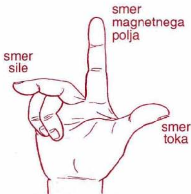
Slika 2. Smer magnetne sile določimo z desno roko: palec kaže dogovorjeno smer električnega toka (od pozitivnega priključka izvira k negativnemu), kazalec smer magnetnega polja in sredinec smer sile. Pri dogovorjeni smeri toka k nam, ko se negativni elektroni gibljejo od nas, deluje nanje magnetno polje proti levi.
