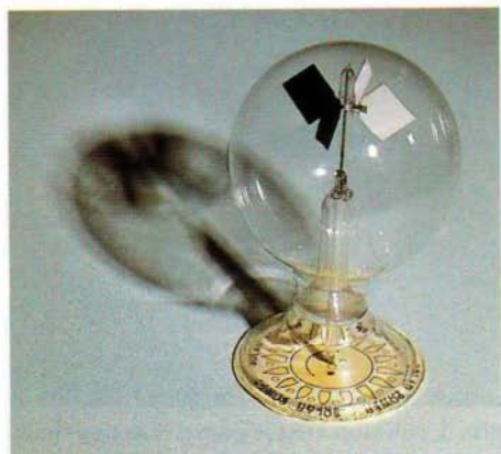
Svetlobni mlinček iz fizikalne zbirke: neosvetljen miruje (levo), osvetljen se vrti (desno). Slika k članku na strani 130.
