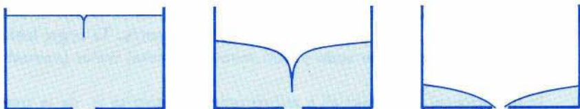
Slika 2. Oblika vrtinca v odvisnosti od višine vode v posodi.
