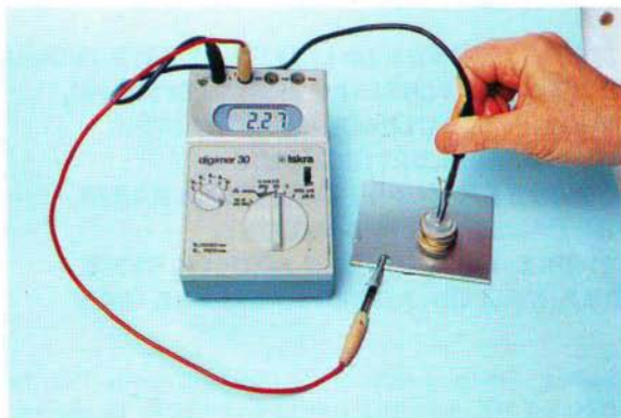
Baterija petih Voltovih členov s kovanci za 5 tolarjev in 50 stotinov. Gonilna napetost je 2,27 V (foto Marjan Smerke).
