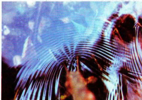
Slika 1. Interferenčne proge pri kapilarnih valovih na dveh ovirah.
