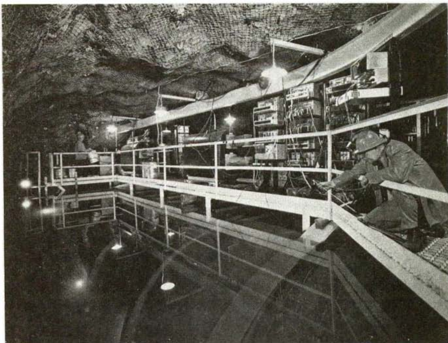
Sl.2 Bazen za "lovljenje" sončevih nevtrinov okoli 1000 m pod površjem Zemlje
