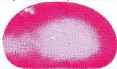
Slika 2. Kapljica vode na vroči kovinski plošči nad mejno temperaturo Leidenfrostovega pojava. Kapljica počiva na tanki plasti pare in počasi izpareva. Ta slika in prejšnja sta vzeti iz Walkerjevega članka v Scientific Americanu.
