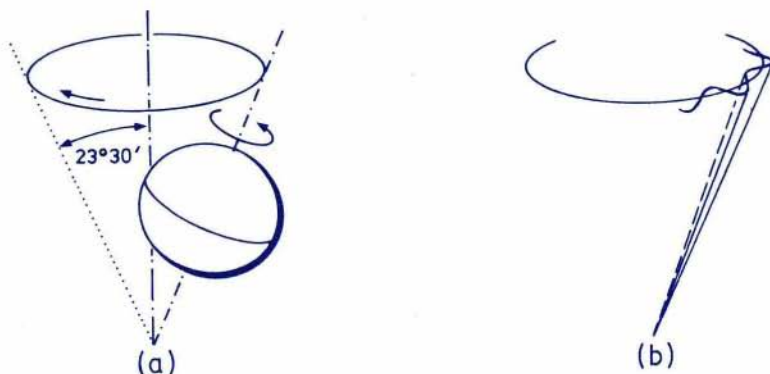
Slika 32. Precesija in nutacija Zemlje. Pri precesiji opiše zemeljska os v okoli 26 000 letih plašč stožca, ker deluje Sonce na izbočeni del Zemlje na ekvatorju (a). Pri nutaciji zemeljska os kima s periodo 18,6 leta, ker se os vrtenja ne pokriva povsem z geometrijsko osjo Zemlje in ker Luna ne kroži okoli Zemlje v isti ravnini kot Zemlja okoli Sonca (b).
