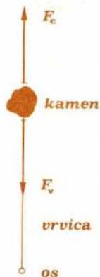
Slika 3a: Kamen v vrtečem se opazovalnem sistemu miruje. Nanj delujeta dve sili, katerih vsota je enaka nič: sila vrvice F_v in centrifugalna sistemska sila F_c .
