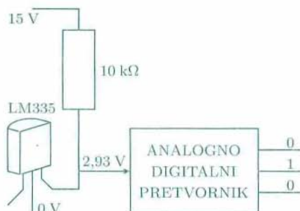
Slika 1. Električni termometer LM335 daje napetost 2,93\text{ V} kot odgovor na temperaturo 293\text{ K} . Analogno digitalni pretvornik odgovori z vzorcem 010.
