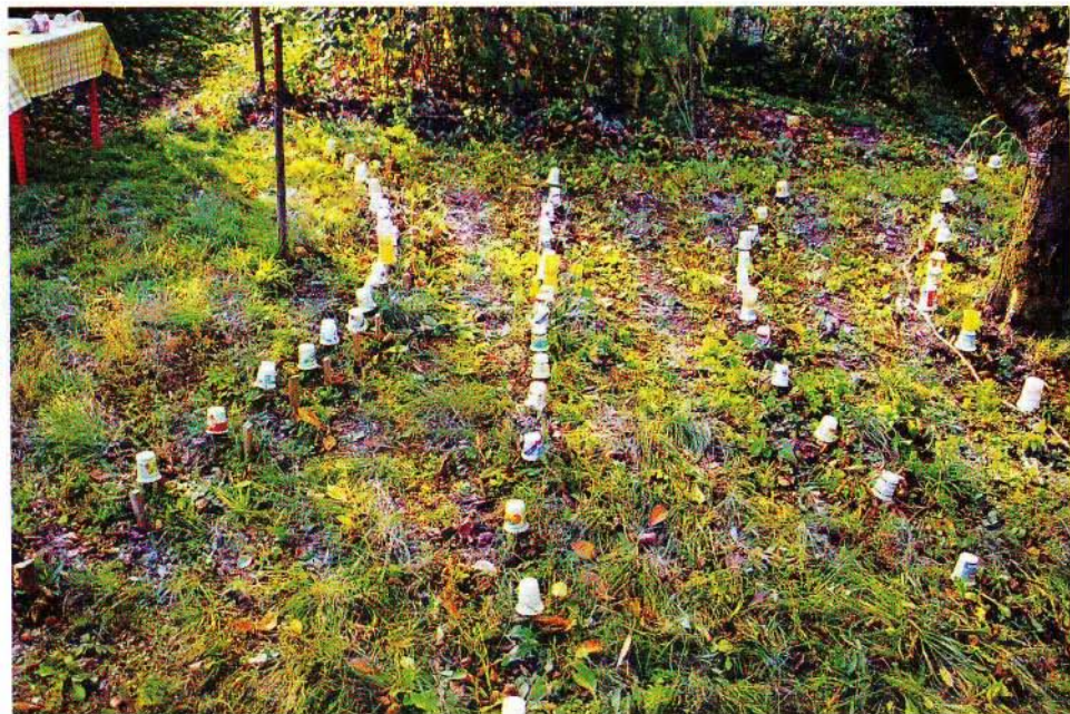
Slika 7. Prikaz rezultatov mojega več kot enoletnega opazovanja sence navpične palice. Vrh sence, ki jo meče palica na vodoravna tla, se premika po hiperboli, ki je vsak dan drugačna. Od spomladanskega do jesenskega enakonočja so hiperbole vbočene (upognjene k palici), od jesenskega do spomladanskega enakonočja so izbočene, vmes – ob enakonočjih pa se izrodijo v premico.
